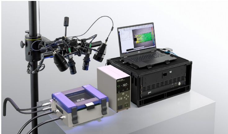
열 변형 계측 시스템 3D DIC + 탁상형 무풍 항온조
